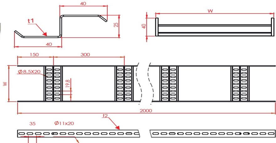
**Морской Кабель-Рост ( С Серии ) W100mm H40mm T1,5mm L:3000mm Горячий Цинк**
