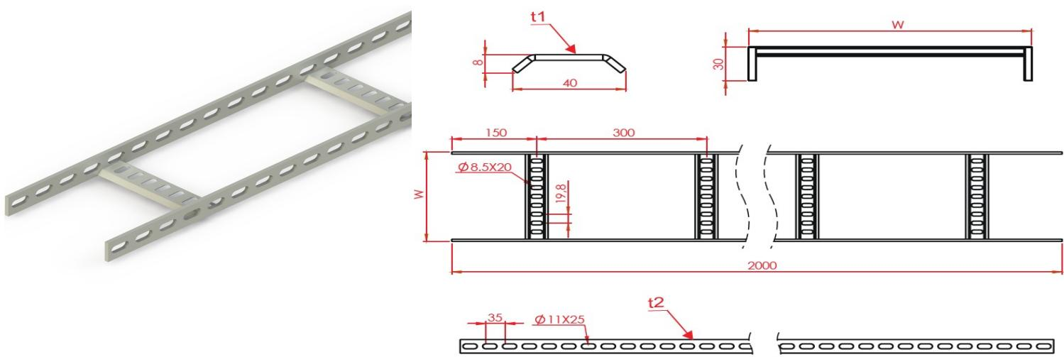
**Морской Кабель-Рост ( В Серии ) W200mm H50mm T1,5mm L:3000mm Горячий Цинк**
