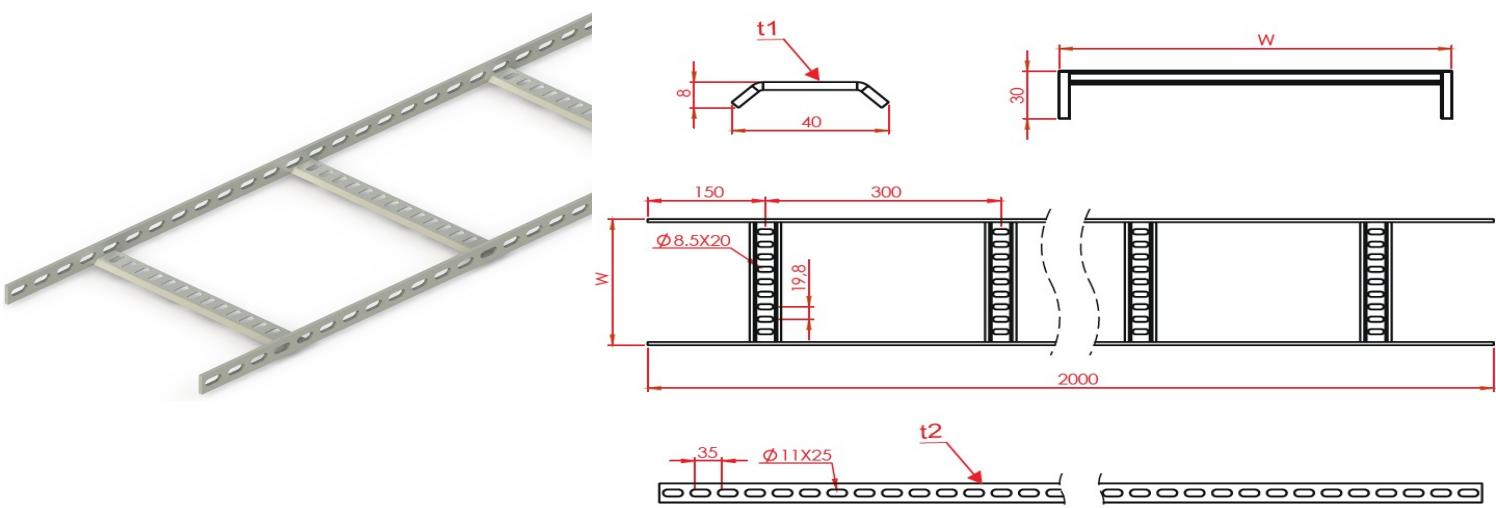
Морской Кабель-Рост ( В Серии ) W300mm H50mm T2mm L:3000mm Горячий Цинк
