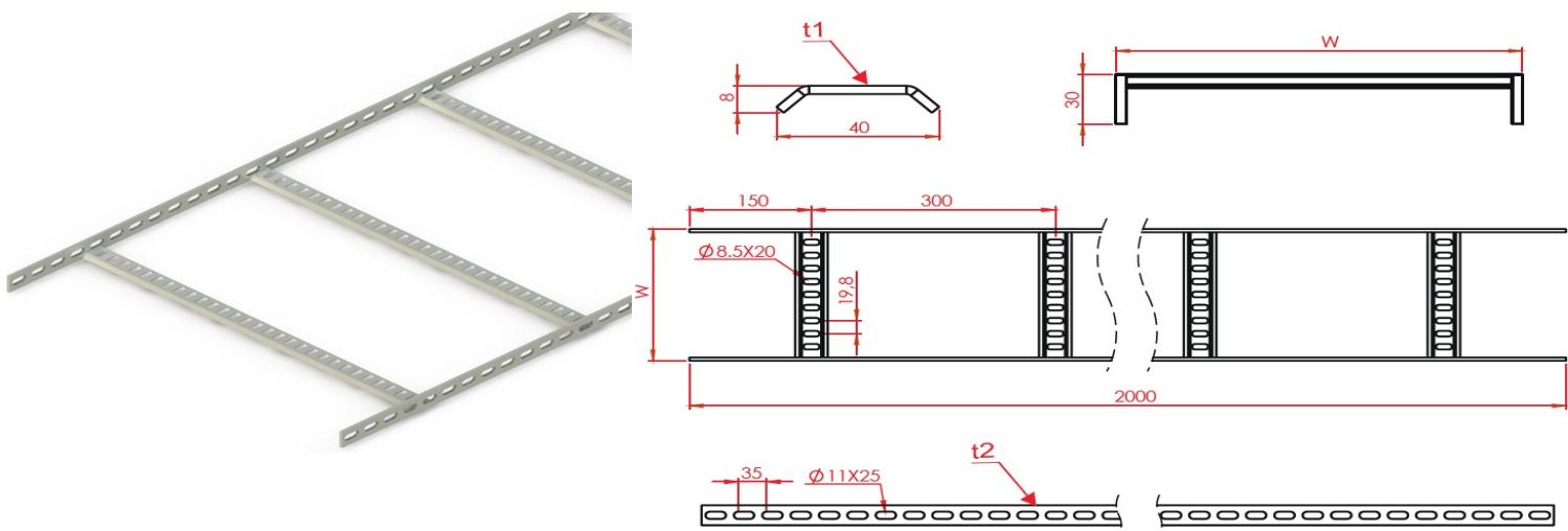
**Морской Кабель-Рост ( В Серии ) W600mm H30mm T2mm L:3000mm Горячий Цинк**
