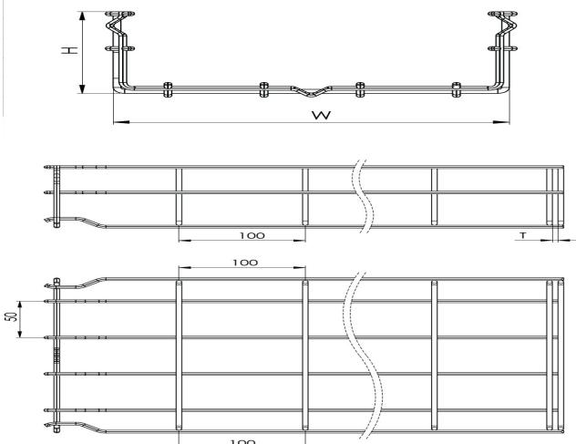
**Проволочный Лоток Быстрой Фиксации W100mm H100mm T4mm L:3000mm Нержавеющая Сталь AISI 304**
