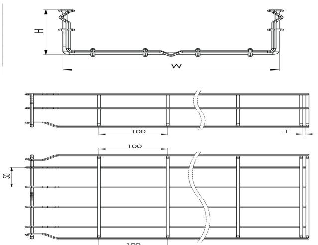
**Проволочный Лоток Быстрой Фиксации W150mm H100mm T4mm L:3000mm Нержавеющая Сталь AISI 304**
