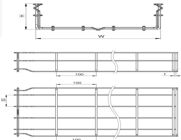
**Проволочный Лоток Быстрой Фиксации W200mm H100mm T4mm L:3000mm Нержавеющая Сталь AISI 304**
