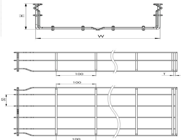
**Проволочный Лоток Быстрой Фиксации W350mm H100mm T4mm L:3000mm Нержавеющая Сталь AISI 304**
