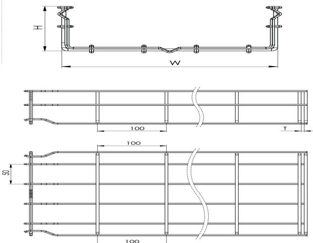
**Проволочный Лоток Быстрой Фиксации W450mm H100mm T5mm L:3000mm Нержавеющая Сталь AISI 304**
