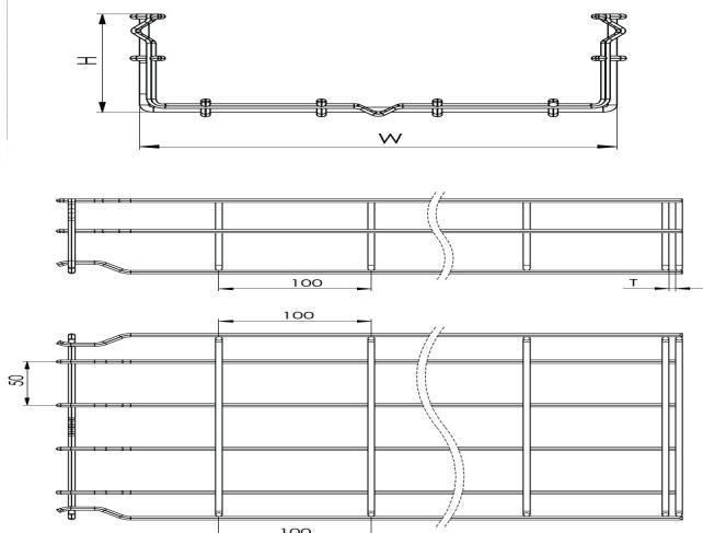
**Проволочный Лоток Быстрой Фиксации W500mm H35mm T4mm L:3000MM Нержавеющая Сталь AISI 304**
