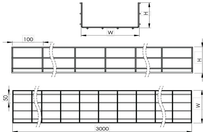
**Проволочный Лоток W200mm H60mm T5mm L:3000mm Нержавеющая Сталь AISI 304**
