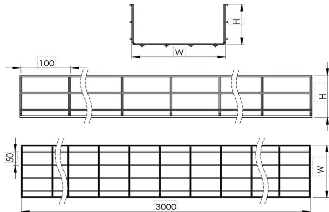
**Проволочный Лоток W300mm H100mm T5mm L:3000mm Электро Оцинковка**
