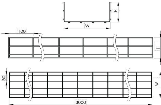
**Проволочный Лоток W300mm H35mm T4mm L:3000mm Нержавеющая Сталь AISI 304**
