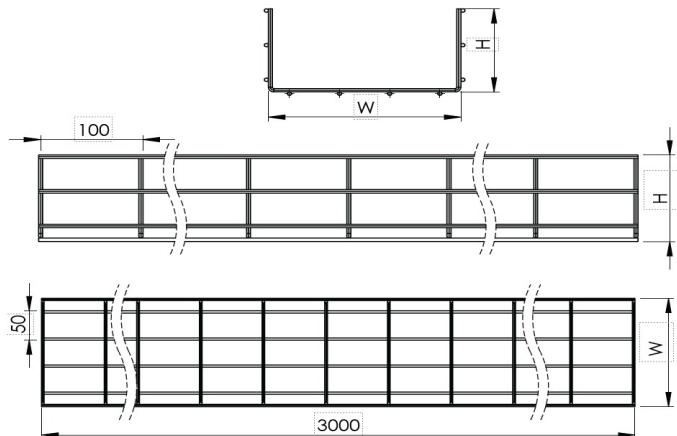
**Проволочный Лоток W300mm H60mm T5mm L:3000mm Нержавеющая Сталь AISI 304**
