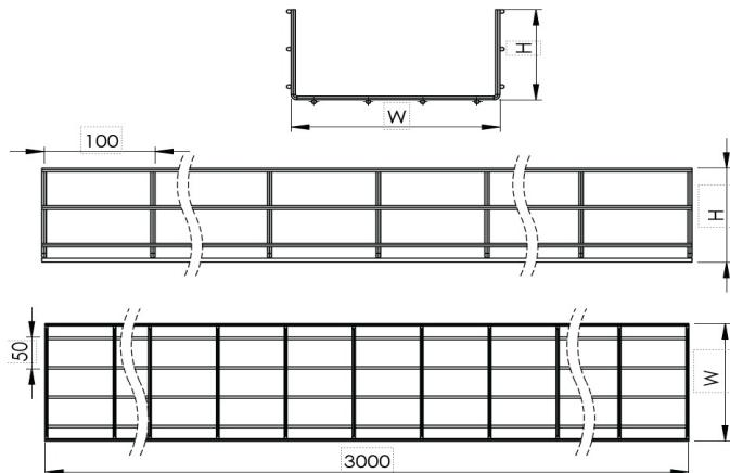
Проволочный Лоток W400mm H60mm T4mm L:3000mm Электро Оцинковка
