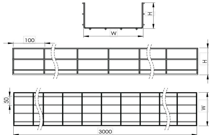
**Проволочный Лоток W450mm H100mm T4mm L:3000mm Электро Оцинковка**
