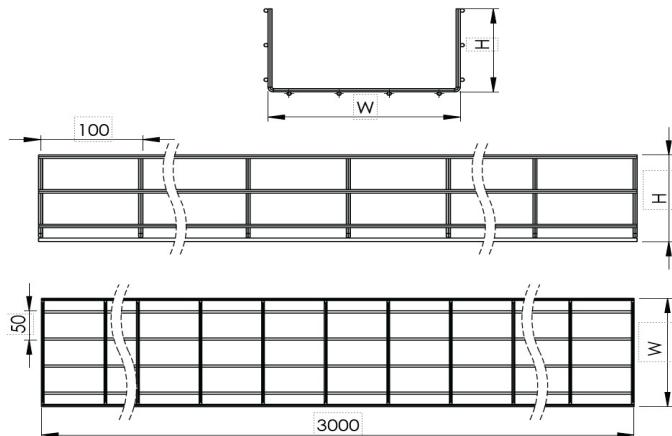
**Проволочный Лоток W500mm H100mm T5mm L:3000mm Нержавеющая Сталь AISI 304**
