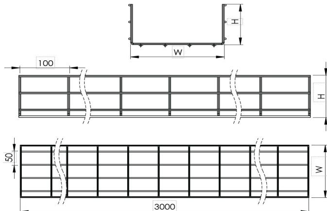
Проволочный Лоток W500mm H35mm T5mm L:3000mm Электро Оцинковка
